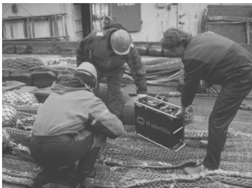
Рис. 2. Установка автономного подводного видеокомплекса в секцию трала с сортирующей системой.
